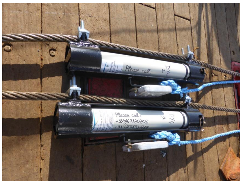
Figure 5. Fixation des C-PODs sur le câble en acier et anode fixée sur la cage
