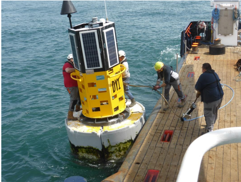
Figure 7. Opération de mise à l'eau des instruments sur une balise de signalisation.
