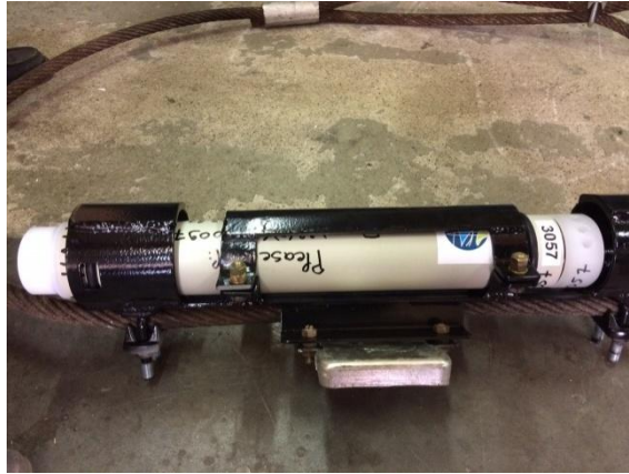
Figure 10. Troisième C-POD déployé sur DY2 lors de la phase 4 (capteur hors de la cage).
