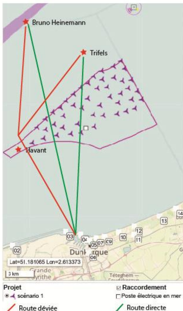
Schéma des contraintes de navigation que pourraient susciter le champ d'éoliennes (plan retravaillé à partir de l'éditeur de carte du site Dunkerque Eolien)
